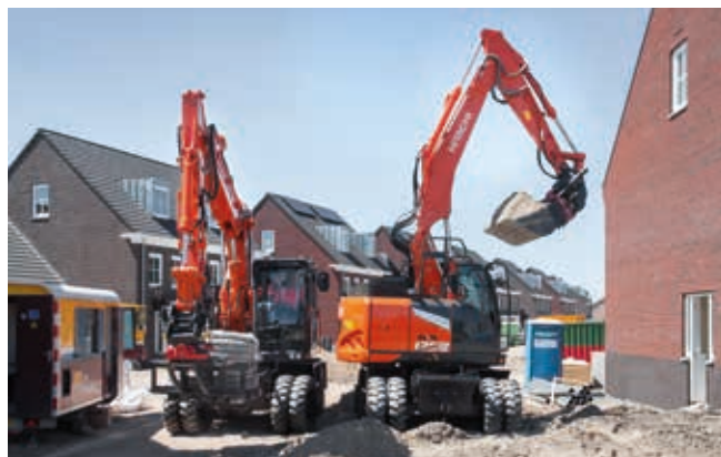
Model ZX135W-7 se otáčí v poloměru 3,5 metrů (1 740 mm dozadu a 1 750 mm dopředu).
