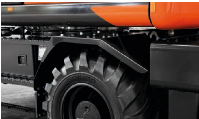
Blatníky na podvozku chrání horní konstrukci a světla před znečištěním a udržují stroj čistý.
