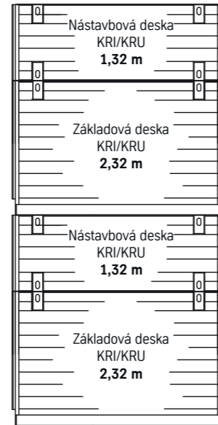
Výška pažící stěny ~7,30 m
